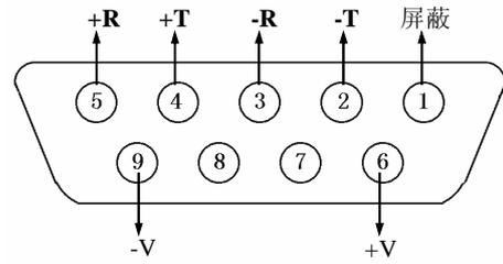
1、传感器的连接采用 9 芯 D 型插头座。图 2-3 标注了各引脚的意义。
